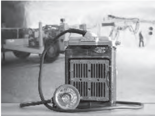
Abbildung 4: Prototyp einer DMFC Grubenlampe
