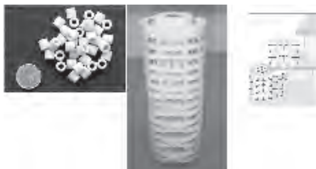
Bild 1: Verschiedene Polymer/Träger-Composite: Ringe (oben links), Ringe in strukturierter Anordnung (Mitte), Strömungsfeld innerhalb einer Packung aus strukturierten Ringen (rechts); Höhe der Packung ca. 20 cm
